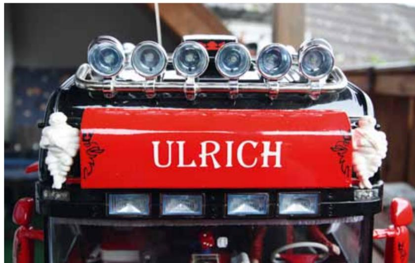
Das Topline-Dach kommt von Verkerk Modelbouw. Allein an dieser Stelle wurden zehn LED zuzüglich der Blinker verbaut
