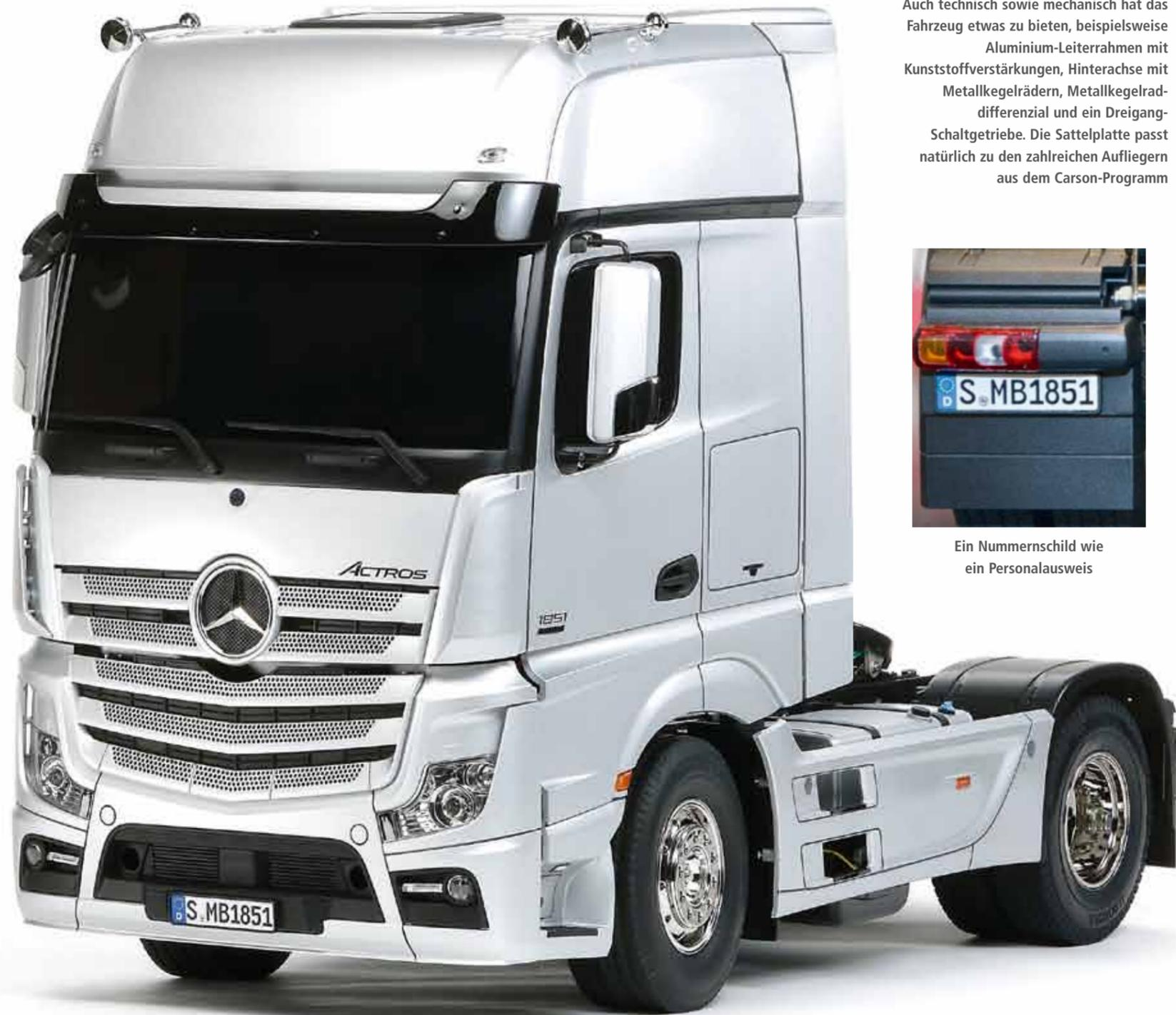
Auch technisch sowie mechanisch hat das Fahrzeug etwas zu bieten, beispielsweise Aluminium-Leiterrahmen mit Kunststoffverstärkungen, Hinterachse mit Metallkegelrädern, Metallkegelrad-differenzial und ein Dreigang-Schaltgetriebe. Die Sattelplatte passt natürlich zu den zahlreichen Aufliegern aus dem Carson-Programm
